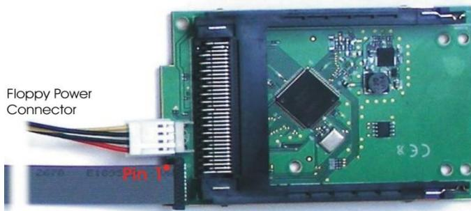
DuoFlex Module (CT oder S2) und CI Modul benötigen den Strom Anschluss (Floppystromstecker)
